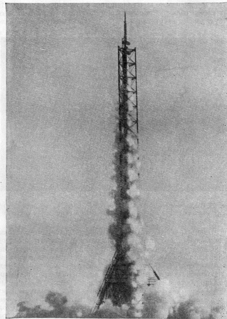
Рис. 54. Ракета «Аэроби» может поднять 45 кг измерительных приборов на высоту порядка 160 км.
