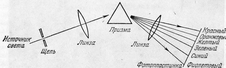
Рис. 107. Схема спектрографа. Оптическое действие линз не показано.
