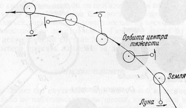
Рис. 34. Движение Земли вокруг центра тяжести системы Земля — Луна. Центр тяжести движется точно по эллипсу вокруг Солнца. Размеры Земли и Луны преувеличены, но относительные положения центра Земли указаны правильно.
