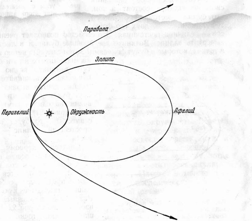
Рис. 22. Различные орбиты вокруг Солнца. Кометы движутся по орбитам, которые представляют собой очень вытянутые эллипсы — почти параболы близ Солнца. Орбиты планет — эллипсы, но очень близкие к окружностям.
