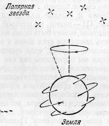
Рис. 44. Волчок и Земля. Оба при вращении описывают конус под действием сил, которые стремятся изменить направление их осей вращения.
