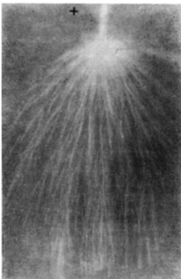
Фиг. II. 15. Импульсная корона при  $S_0 = 200$  см для напряжения  $U_m = 1100$  кв (промежуток с — п)
