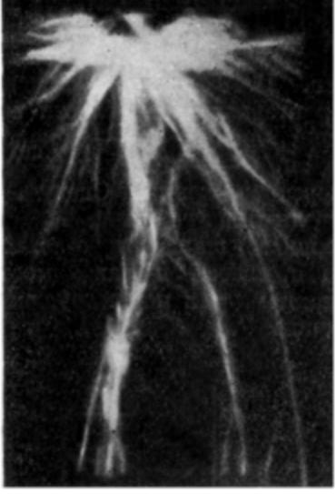
Фиг. II. 22. Многоступенчатая импульсная корона, развиившаяся до плоскости
