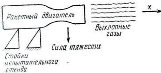
Рис. 4.4.8-1. Статическое испытание ракетного двигателя.
