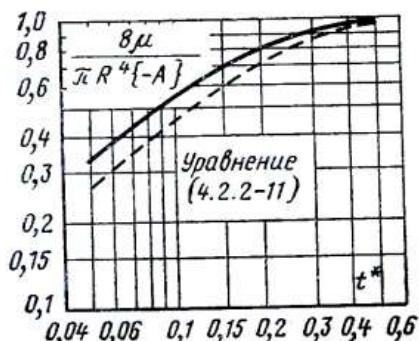
Рис. 4.2.2-1. Сравнение анализа усреднения по площади с точным решением для течения в круглой трубе из состояния покоя.
