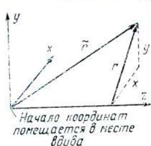
Рис. 10.1.4-1. Системы координат для описания турбулентной диффузии от точечного источника в потоке, имеющем постоянную скорость.
