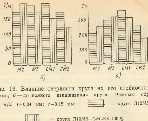
Рис. 13. Влияние твердости круга на его стойкость:
