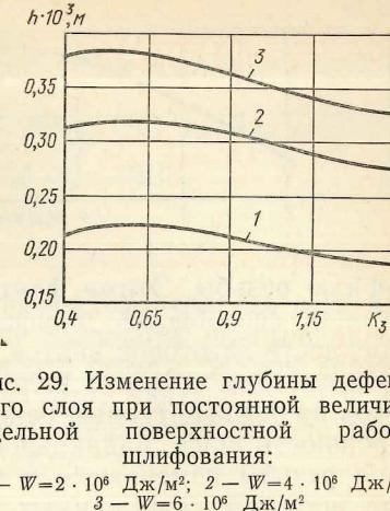
Рис. 29. Изменение глубины дефектного слоя при постоянной величине удельной поверхности работы шлифования:
