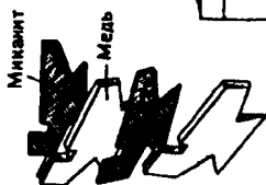
Коллекторные пластины с капроновыми прокладками
