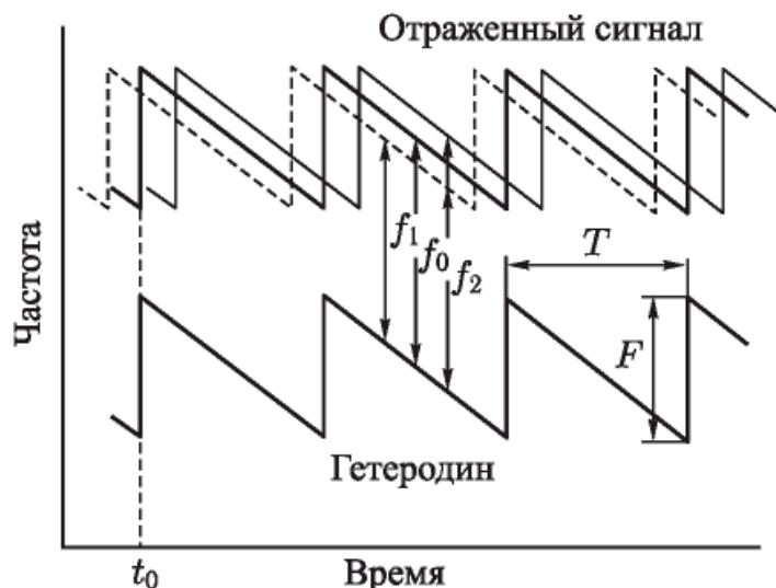
Рис. 17. Изменение частоты при линейной частотной модуляции (ЛЧМ) отраженного сигнала на входе приемника (вверху) и гетеродинного сигнала (внизу).  $t_0$  — расчетное время запаздывания эхо-сигнала;  $f_0$  — номинальная частота;  $f_1$  — частота ниже номинальной, а  $f_2$  — выше номинальной;  $T$  — период модуляции;  $F$  — девиация частоты
