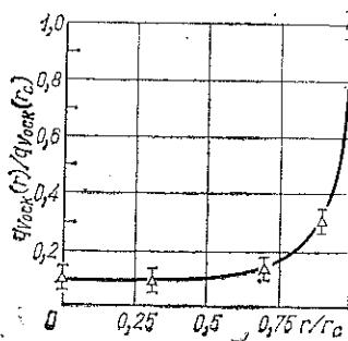
Рис. 4.1. Распределение относительного тепловыделения от осколков деления  $q_{V_{\text{оск}}}^{\text{МН}}(r)$  по радиусу сердечника твэла [30] (точки — эксперимент; линия — расчет;  $r_c$  — внешний радиус топливного сердечника)
