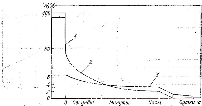
Рис. 9.4. Структура изменения мощности после остановки реактора:
