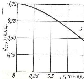
Рис. 6.1. Зависимость тепловыделения в поглощающем стержне  $Q_{ct}$  от его расположения в активной зоне реактора  $r$
