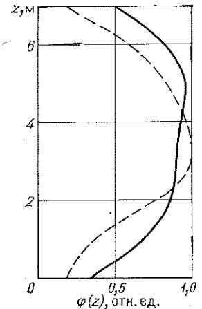
Рис. 8.10. Распределение плотности потока тепловых нейтронов по высоте в реакторе РБМК [59]:
