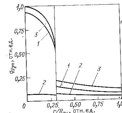
Рис. 8.9. Распределение тепловыделения от  $\gamma$ -квантов и замедляющихся нейтронов в ячейке реактора РБМК:
