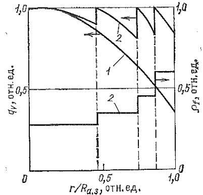
Рис. 8.5. Распределение тепловыделения ( $q_v$ ) и концентрации делящегося вещества ( $\rho_f$ ) по радиусу реактора при осуществлении зонного профилирования:
