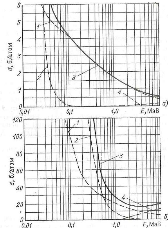
Рис. 7.1. Зависимость полного сечения взаимодействия и отдельных его составляющих от энергии  $\gamma$ -квантов для кислорода (а) и свинца (б):
