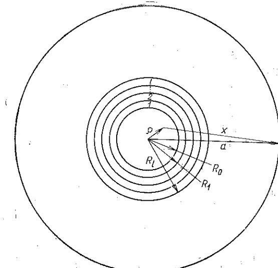
Рис. П2.3. Схема для расчета плотности потока и тока  $\gamma$ -излучения снаружи источника в сферической геометрии ( $R_0$  — радиус источника;  $R_l$  — внешний радиус  $l$ -й зоны;  $l$  — индекс зон вне источника;  $a$  — радиус точки наблюдения;  $P$  — радиус текущей точки источника)
