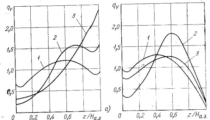
Рис. 8.2. Зависимость распределения тепловыделения по высоте активной зоны от глубины погружения поглощающих стержней для случая нижнего торцевого отражателя без поглотителя (а) и с поглотителем (б):
