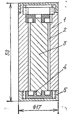
Рис. 12.3. Конструкционная схема борного счетчика [76]:
