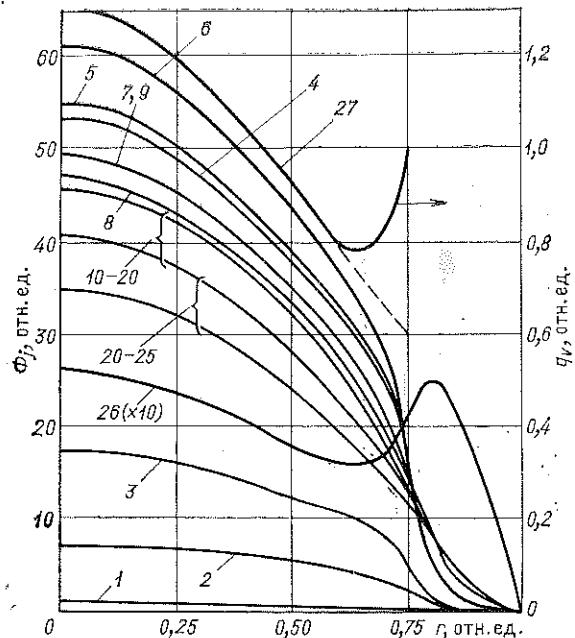
Рис. 2.4. Распределение плотности потоков нейтронов по радиусу сферического реактора с отражателем, с графитовым замедлителем (типа ВГР-50):
