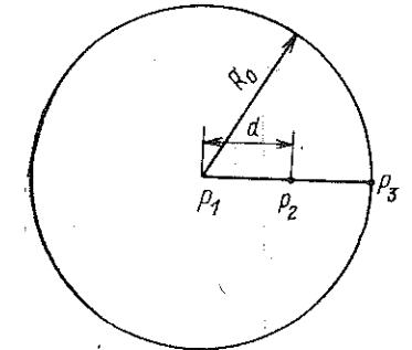
Рис. П2.4. Схема для расчета плотности потока и тока  $\psi$ -излучения внутри источника сферической геометрии ( $R_0$  — радиус источника;  $d$  — радиус точки наблюдения;  $P_1$  — точка в центре источника;  $P_2$  — точка внутри источника;  $P_3$  — точка на внешней поверхности источника)
