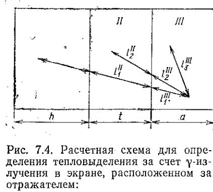
Рис. 7.4. Расчетная схема для определения тепловыделения за счет  $\gamma$ -излучения в экране, расположенному за отражателем:
