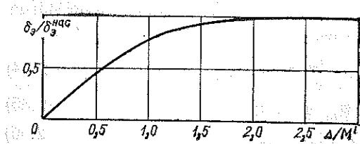
Рис. 2.2. Зависимость эффективной добавки за счет отражателя от его толщины
