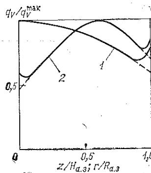
Рис. 8.1. Распределение тепловыделения по радиусу (1) и высоте (2) активной зоны реактора на тепловых нейтронах
