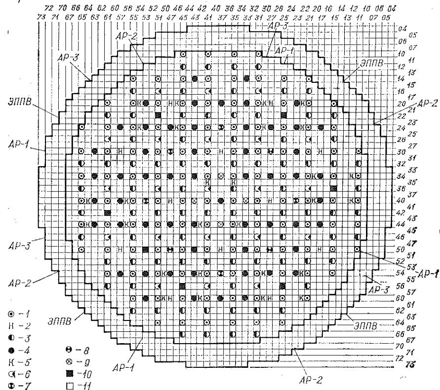
Рис. 18.1. Схема размещения детекторов и поглощающих стержней в реакторе РБМК [58]:
