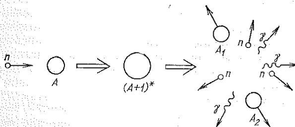
Рис. 1.1. Схема деления ядра
