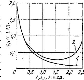
Рис. 8.11. Распределение тепловыделения по толщине отражателя без учета (1) и с учетом (2) источников  $\gamma$ -квантов в конструкционных материалах за отражателем (начало координат принято на границе отражателя и активной зоны)
