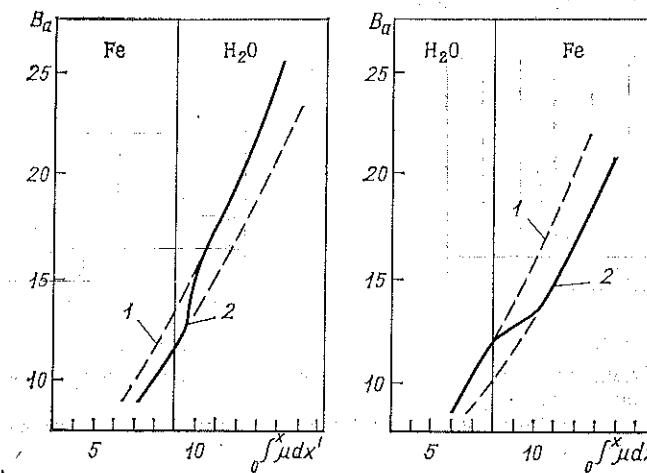
Рис. П1.1. Зависимость фактора накопления от расстояния от плоского источника для двухслойной среды железо — вода и вода — железо:
