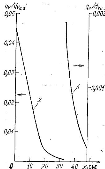
Рис. 8.16. Радиальное распределение тепловыделения в конструкциях, окружающих активную зону реактора ВВЭР, включая корпсус: 1 — тепловыделение в корпсусе; 2 — тепловыделение во внутренних конструкциях
