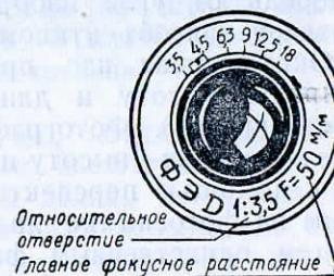
Рис. 10. На оправе передней линзы объектива обозначаются главное фокусное расстояние и относительное отверстие
