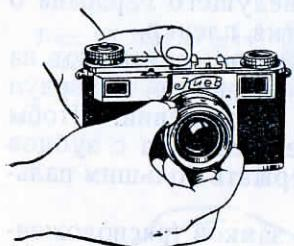
Рис. 95. Приведение камеры в рабочее состояние
