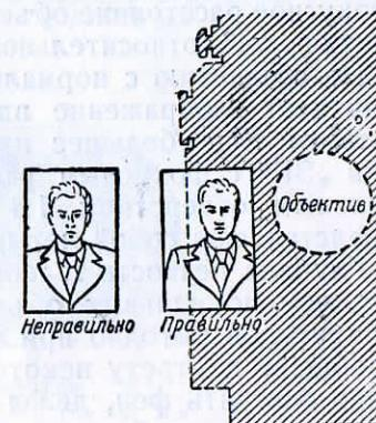
Рис. 71. Поправка при съемке на близких расстояниях
