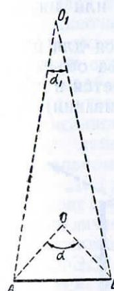
Рис. 17. Принцип оптического дальномера
