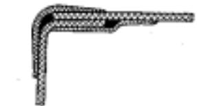
Рис. 67. Узлы соединений стекол с панелями.
