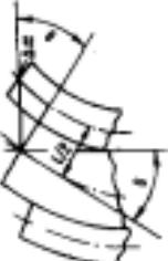
Рис. 52. Схема деформаций kleевого шва при изгибе соединений с накладками.
