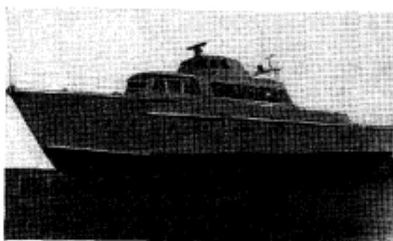
Рис. 12. Катер с пластиковой палубой и рубкой.
