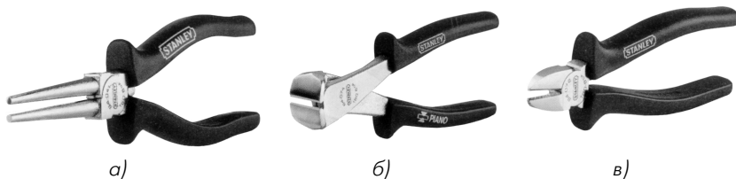
Рис. 1.6. Круглогубцы (а), кусачки торцовые (б) и боковые (в)
