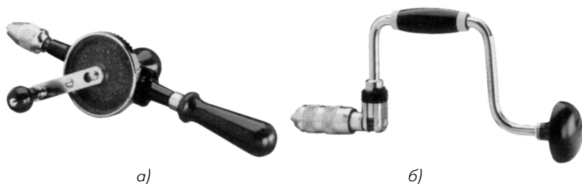
Рис. 1.10. Дрель ручная (а) и коловорот (б)
