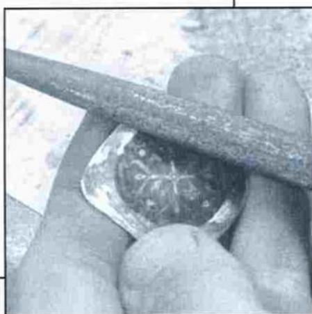
*Фото 4.* Снова прокуйте, как во втором этапе. Окончательная обработка молотком должна заключаться в легком выравнивании брикета и сглаживании отметин от ковки, чтобы добиться равномерной толщины. Затем гладко ошилите напильником с тонкой насечкой.
