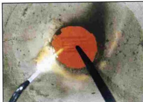
Признаки, приведенные ниже, указывают на то, что температура стала слишком высокой. Выключите только кислород и снизьте подачу газа. Уменьшите время выдержки в соответствии с тем, насколько вы полагаете, брикет был подвержен высокой температуре, но не выключайте газ до тех пор, пока металлы полностью не отвердеют.
