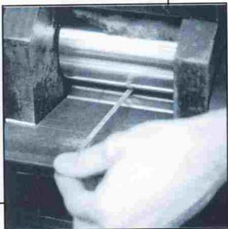
*Фото 8.* Мягко прокатайте эту заготовку до идеальной прямоугольной (или полукруглой) проволоки длиной около 23 см. В процессе проверяйте ее обратную сторону и удаляйте лишний припой, который может закрывать рисунок с внутренней поверхности браслета. Прокатывайте осторожно и исправляйте любые искривления или неровные изгибы, которые могут возникнуть в процессе прокатки.
