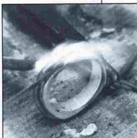
Фото 11. Срежьте или спилите обвязочную проволоку. Не пытайтесь свободно ее снять, поскольку она может оказаться припаянной. А это может порвать или отделить слои мокуме. После снятия всей обвязочной проволоки, погрузите кольцо в отбел для удаления остатков флюса.
