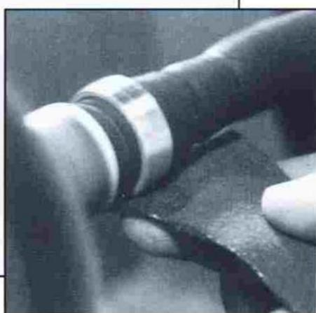
Фото 12. Мой любимый способ финишной отделки подобных изделий - надеть кольцо на диск для полировки внутренней поверхности колец и обработать его на шлифовальном станке. Используйте наждачную бумагу №180, а затем №320. Это придает кольцу завершенный вид механической обработки и занимает всего несколько минут.
