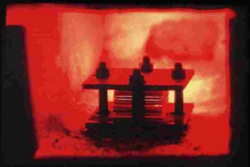
*«Я использую один и тот же пропановый горн и для кузнечной сварки стали, и для мокуме гане. Он развивает достаточную температуру и позволяет контролировать атмосферу».*
