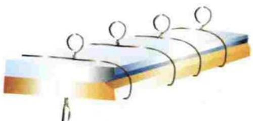
**1.** Подберите металлы для пайки согласно их совместимости по параметрам ковкости и способности подвергаться пайке серебряным припоем. Обычно это медь, медные сплавы, серебро и золото. Я использую томпак (95 Cu, 5 Zn) и серебро.
