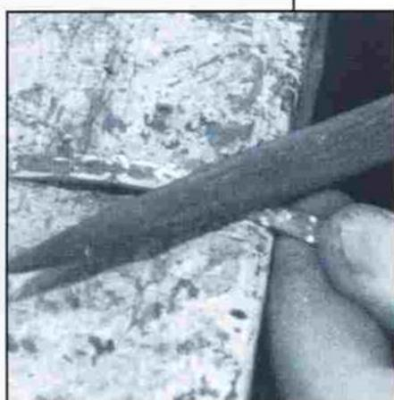
Фото 3. Вырежьте полосу металла толщиной 22 B&S (около 0,6 мм) (в этом примере серебра) такой же ширины, что и полоса мокуме. Оберните ее вокруг ригеля и подрежьте края под конкретный размер кольца. Проверьте, что место соединения максимально плотно, и пропаяйте его тугоплавким припоеем.
