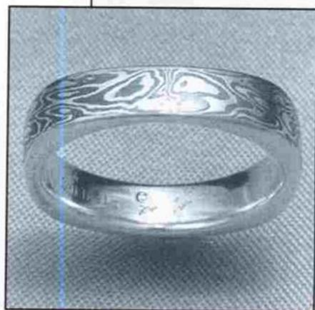
Фото 14. Готовое кольцо с мокуме - облицовкой. Заметьте, что шов, где соединяются края полоски мокуме находится сверху по центру. Кольцо из стерлингового серебра с мокуме - накладкой из меди и серебра.
