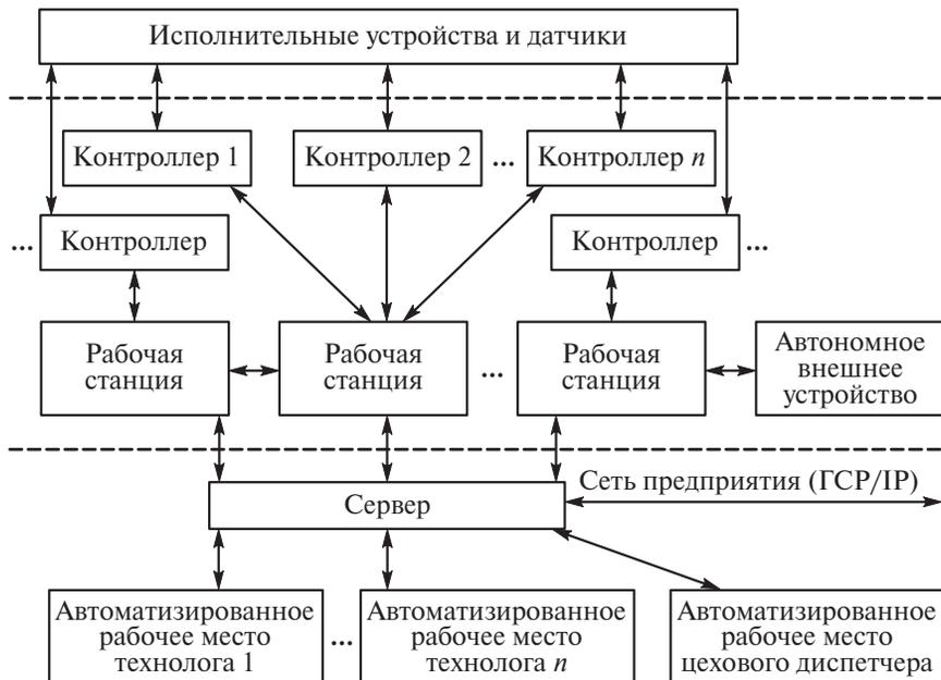
Рис. 8.12. Пример производственного участка с использованием NC-2000
