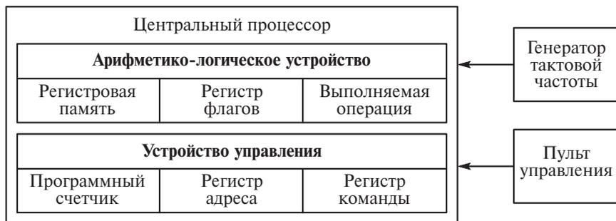
Рис. 3.4. Фрагмент схемы ЭВМ
