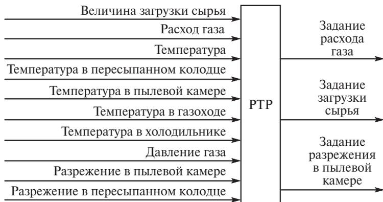
Рис. 8.9. Регулятор теплового режима
