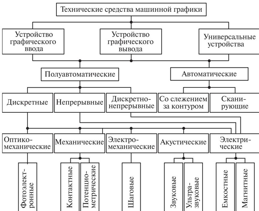
Рис. 8.37. Технические средства машинной графики
