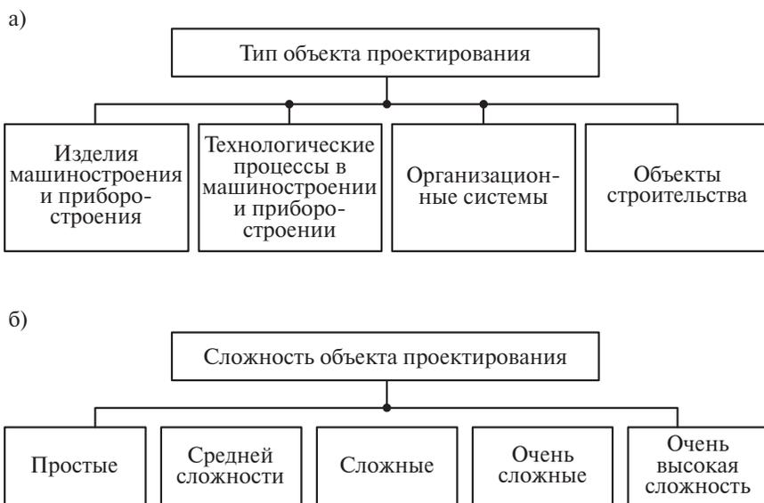
Рис 8.21. Классификация САПР по типу (а) и сложности (б) объекта проектирования
