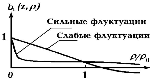
**Рис.2.4.6.** Корреляционные функции интенсивности ( $\rho_0$  - радиус корреляции для слабых флуктуаций).
