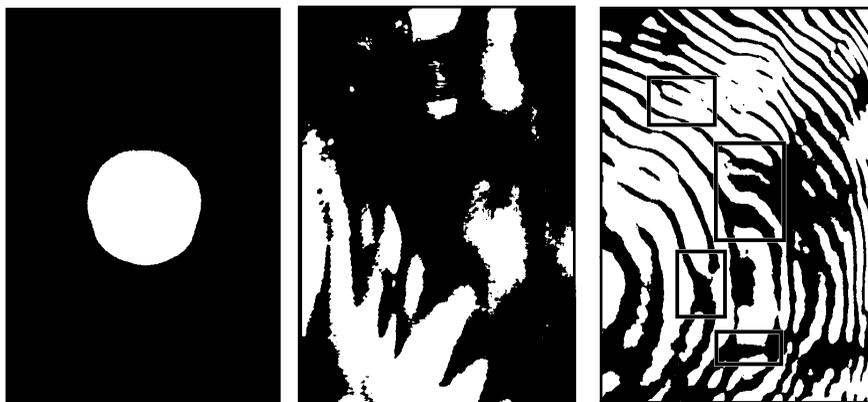
**Рис. 2.7.5.** Фотографии (а,б) и интерферограмма (в) лазерного пучка; а - исходный пучок, б - пучок после прохождения атмосферной трассы.
