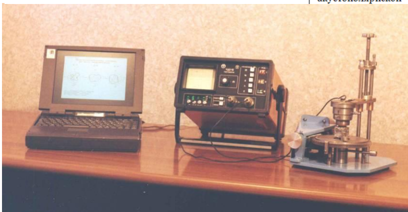
Рис. 1. Программно-аппаратный комплекс для исследования упруго-анизотропных свойств твердых сред акустополаризационным методом.
