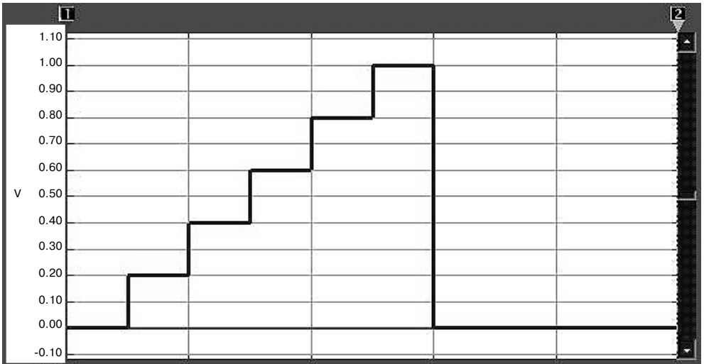
Рис. 4.40. Лестничный сигнал с пятью ступеньками
