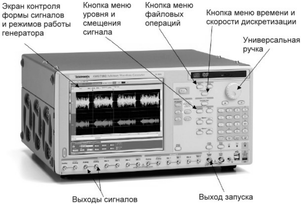
Рис. 4.68. Внешний вид и органы управления генератором AWG7102
