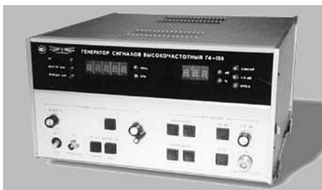
Рис. 1.31. Современный ВЧ ГСС Г4-158А
