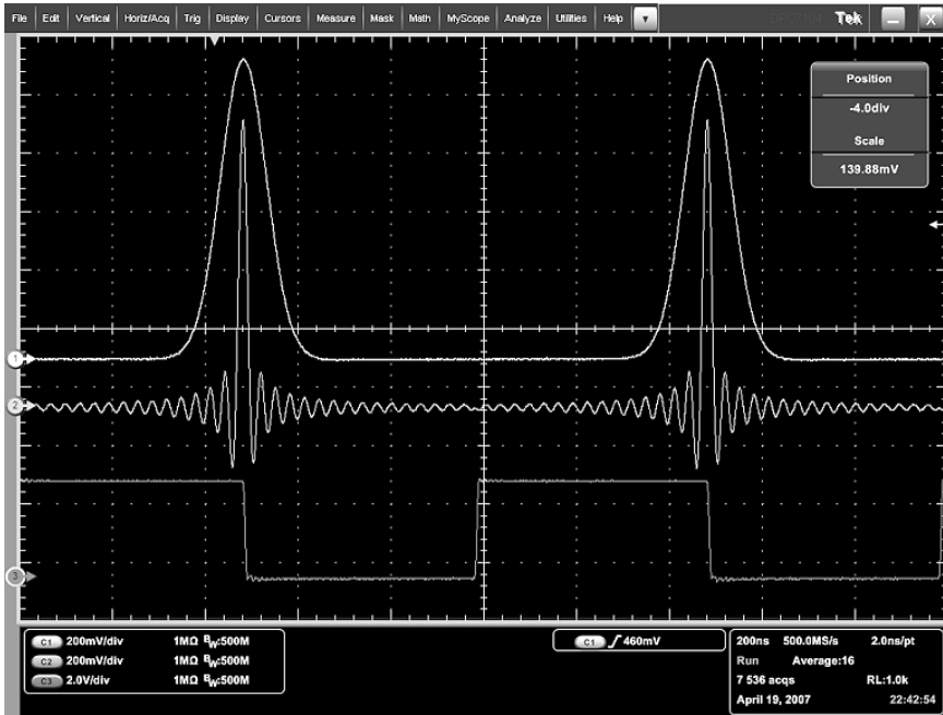
Рис. 4.31. Осциллограммы сигналов двух функций: Гаусса (сверху) и \sin(x)/x (снизу)
