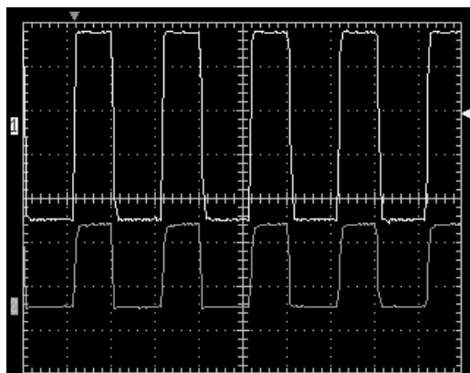
Рис. 3.30. Осциллограммы прямоугольного и TTL сигналов на частоте 1 МГц
