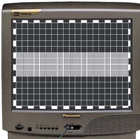
Рис. 2.31. Вид телевизора с изображением, создаваемым одним из тестовых сигналов (черно-белая рамка)
