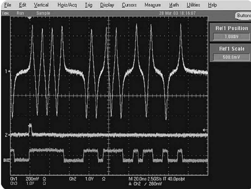
Рис. 4.71. Осциллограммы импульсов смешанных сигналов (сигнал маркерного выхода показан снизу)
