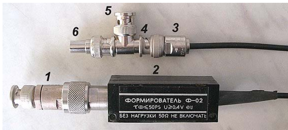
Рис. 5.28. Внешний вид формирователя \Phi -02 и СВЧ узлов импульсного 50-омного тракта (1 — переходник к входному разъему CNN, 2 — формирователь \Phi -02, 3 — разъем выхода формирователя, 4 — тройник, 5 — выходной разъем, 6 — 50-омная заглушка)
