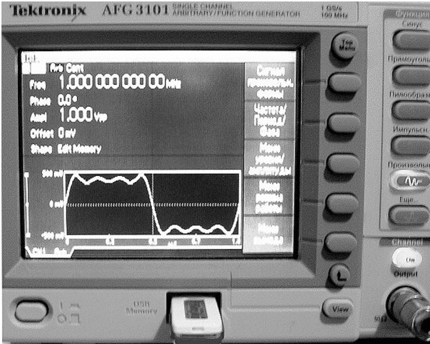
Рис. 4.62. Снимок экрана генератора AFG 3101 с графиком загруженного сигнала
