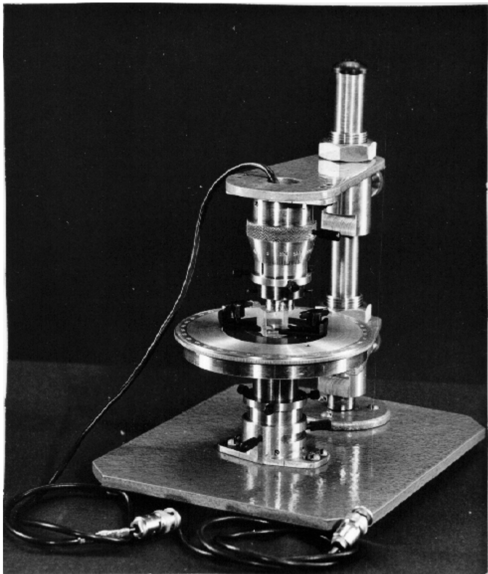
Рис.4.9. Общий вид акустополярископа с поворотной платформой (по авт. свид. № 1281993). Вариант с одной стойкой.
