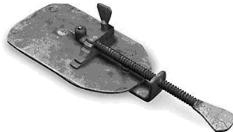
Рис. 10.8. Внешний вид микроскопа Левенгука (длина около 7 см).
