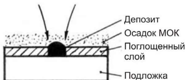
Схема фото-активированной химической реакции разложения МОК в газовой фазе.
