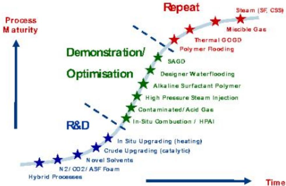
Рис. 28. Степень технической проработанности различных методов повышения нефтеотдачи [79]
