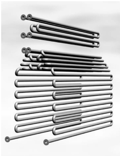
Рис. 2.71. Змеевик трубчатой печи типа ГС
