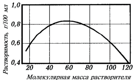
Рис. 4.12. Зависимость растворимости парафина с температурой плавления 54 °С в сжиженных и жидких парафиновых углеводородах от их молекулярной массы
