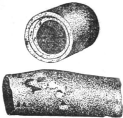
Рис. 2.78. Отдулины на печной трубе
