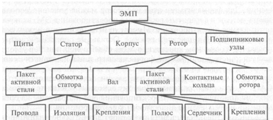
Рис. 10.5. Схема декомпозиции ЭМП на узлы и элементы
